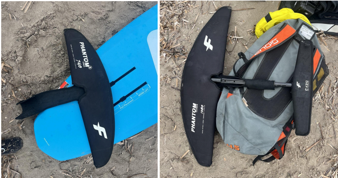
Figure 6 : Les 2 foils testés avec 2 planches, suivant ces combinaisons : (A) foil ENSIS MANIANC INFINITY ACE 1140 span : 92.5 cm + planche ENSIS 5'7" 21" 72L (B) foil PHANTOM CARBON 1280 span : 87 cm + planche CHASE. (C) foil ENSIS MANIANC INFINITY ACE 840 span : 79.5 cm + planche ENSIS 5'7" 21" 72L (D) foil PHANTOM CARBON 740 span : 69,5 cm + planche ENSIS 5'7" 21" 72L.
