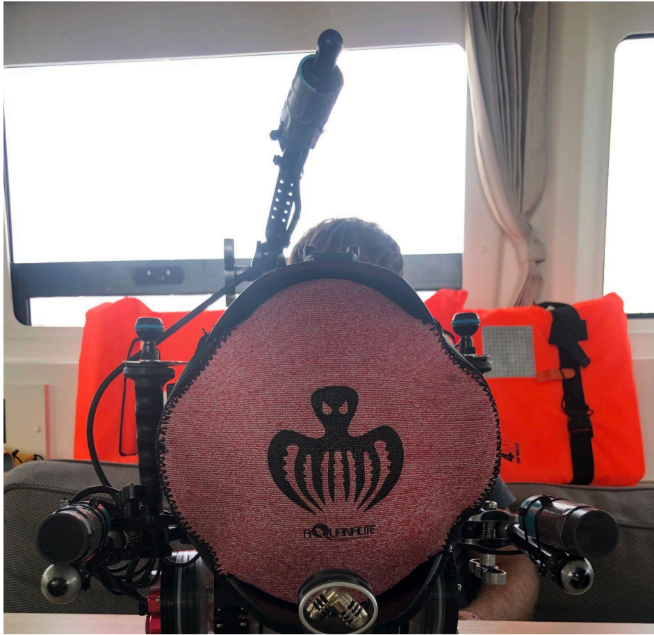
Fig. 1.1. Antenne créée (HG et al.) pour la mission. Le dôme vidéo est au centre du triangle des 3 hydrophones. le CR3 est en haut, les SQ sur les bord en bas. Distance hydrophone SQ1 et SQ2 : 31 cm, SQ1 et CR3 : 22 cm, SQ2 et CR3 : 26 cm.
