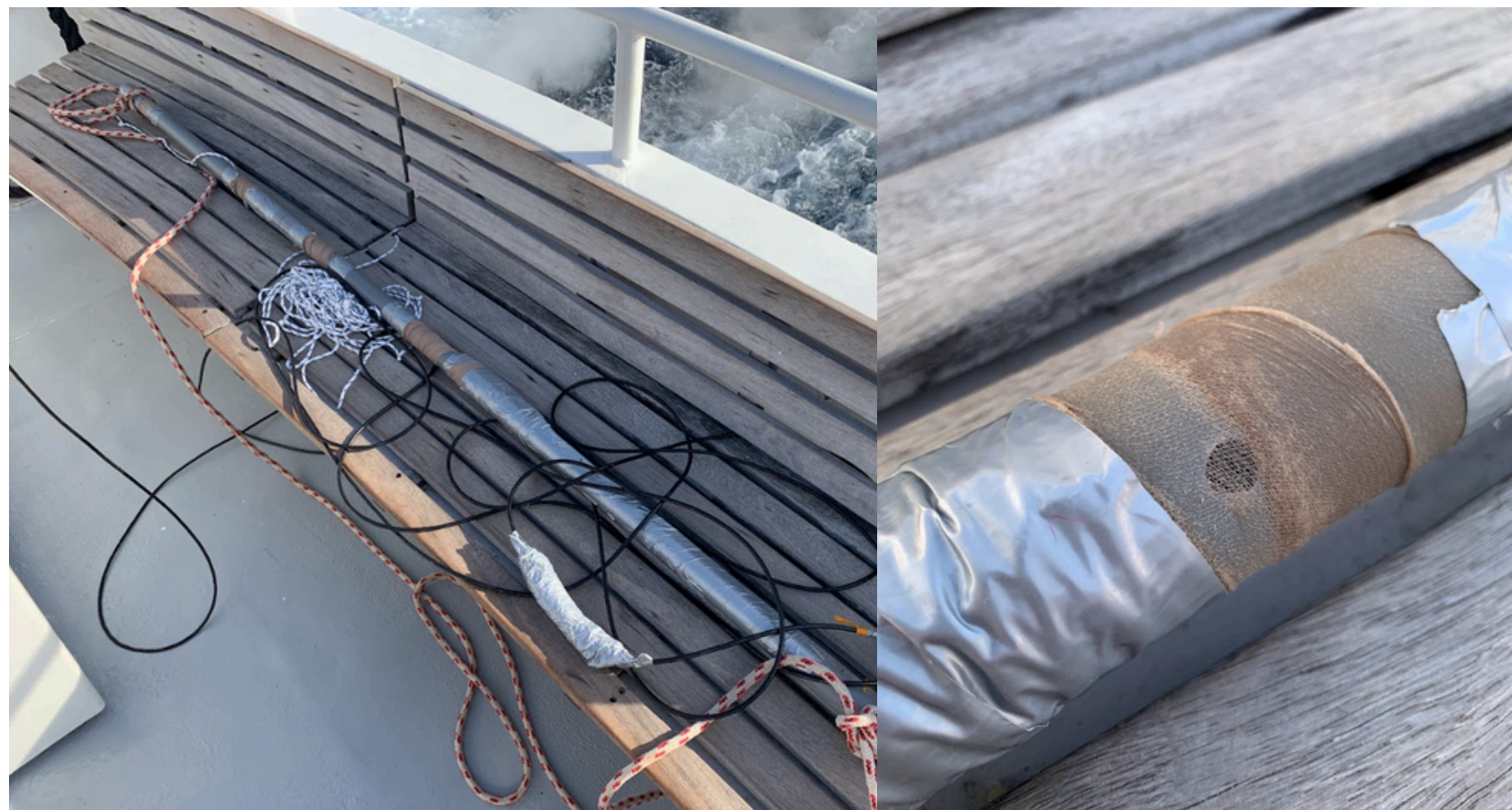
Figure 2.4 : Antenne constituée de deux hydrophones. Le dispositif est troué, ce qui permet à l'eau d'entrer dans l'antenne et une chaussette permet de casser le flux, ce qui réduit le bruit généré par ces trous.
